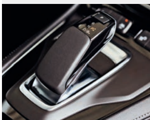
Extravagant geformter Wählhebel für die Automatik mit acht Stufen (Kia: 6).
