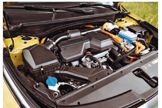
Kia Sportage: Der 1.6er leistet 180 PS, die E-Maschine steuert weitere 91 PS dazu, Allrad über hydraulische Lamellenkupplung.
