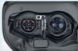
Der Eclipse bietet im Test als einziger eine DC-Schnelllademöglichkeit.
