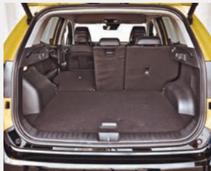
Fondlehne dreigeteilt und vom Heck aus zu entriegeln, ebener Boden.
